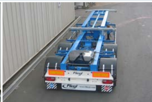
Das Combi-Chassis für die skandinavischen Länder: 20 Fuß vorne, einfach verschiebbar zur heckbündigen Be- und Entladung und einer Aufnahme für einen weiteren Sattelaufleger.
