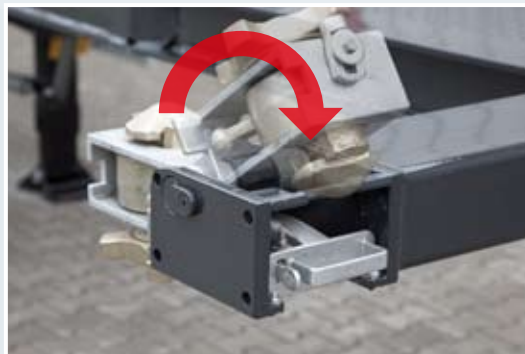
Einfache Bedienung der klappbaren Frontverschlüsse.
