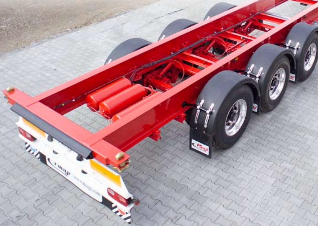
Containerchassis für 1 x 40 Fuß Container, Ultra Light (ab 3.800 kg Eigengewicht).
