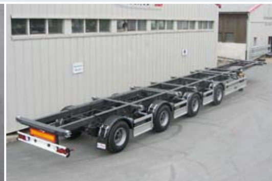
4-Achs Containerchassis für bis zu 3 x 20 Fuß Container.
