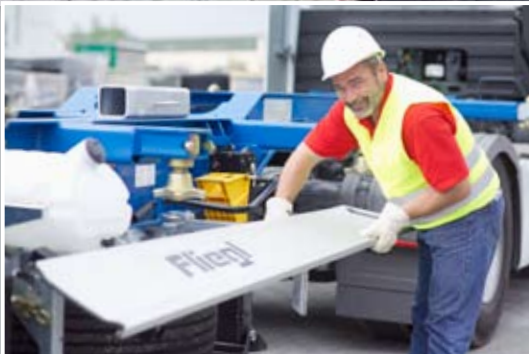
Klappbarer stabiler Seitenanfahrerschutz.
