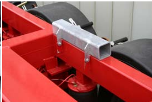
Stabile Füllböcke, klappersicher im Rahmen untergebracht.
