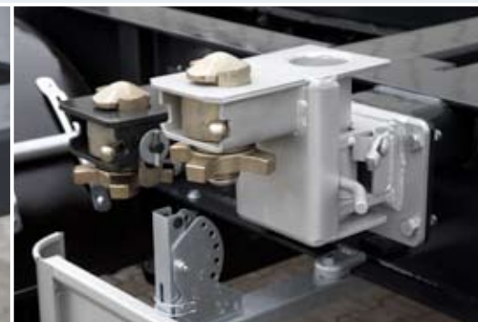
Containerverriegelungen durch Schraubversion leicht austauschbar.
