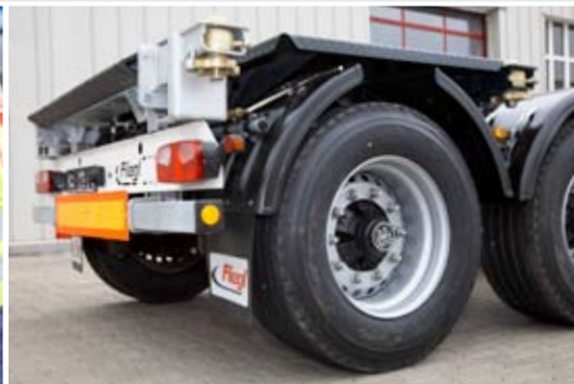
Stabiler Rammschutz quer. Unterfahrerschutz und Leuchten-träger sind als getrennte Bauteile gut geschützt angebracht und somit im Schadensfall einfach und günstig zu ersetzen.
