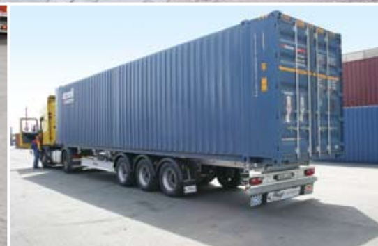
SDS 380 Gooseneck mit Frontausschub – 45 Fuß ohne Ausnahmegenehmigung*. Für 20 Fuß heckbündig, 30 Fuß, 2 x 20 Fuß, 40 Fuß und 45 Fuß.
