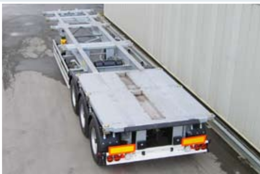
Containerchassis starr (Heavy Duty), gerade mit Auffangwanne in Exportausführung.
