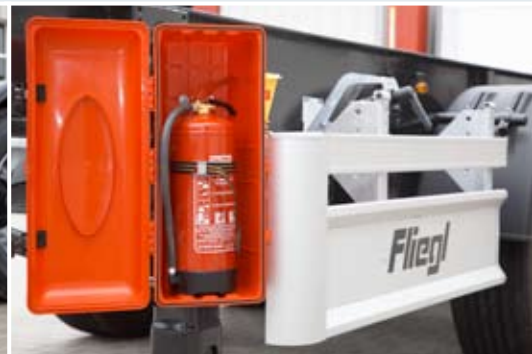
Feuerlöscher als Gefahrgutausstattung, z. B. beim Chemie-Containerchassis.
