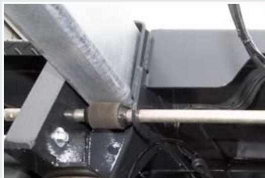
Der Heckausschub ist auf Gummirollen gelagert und im Bedarfsfall einfach auszuwechseln.
