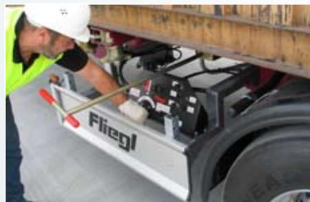
Bild 4: Federspeicherfeststellbremse anziehen Bolzenarretierung für Mittelteleskop lösen.
