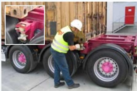
Bild 2: Schlittenverriegelung lösen.
