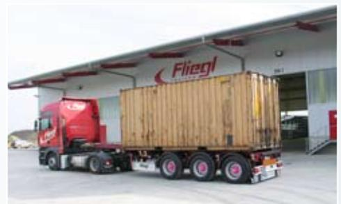
Bild 6: Fertig: mit wenigen Handgriffen ist der ausgeladene Container aus der Mittenposition für die heckbündige Entladung verschoben worden.
