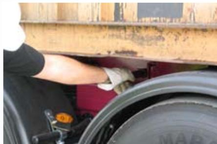
Bild 3: Luft anheben, Bolzen hinten lösen und arretieren Luftfederung absenken.
