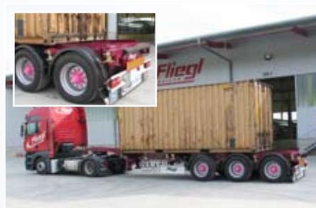
Bild 5: Durch Rückwärtsfahren bis zu 20" Heckbündig-Aufnahme wird der Container nach hinten geschoben.
